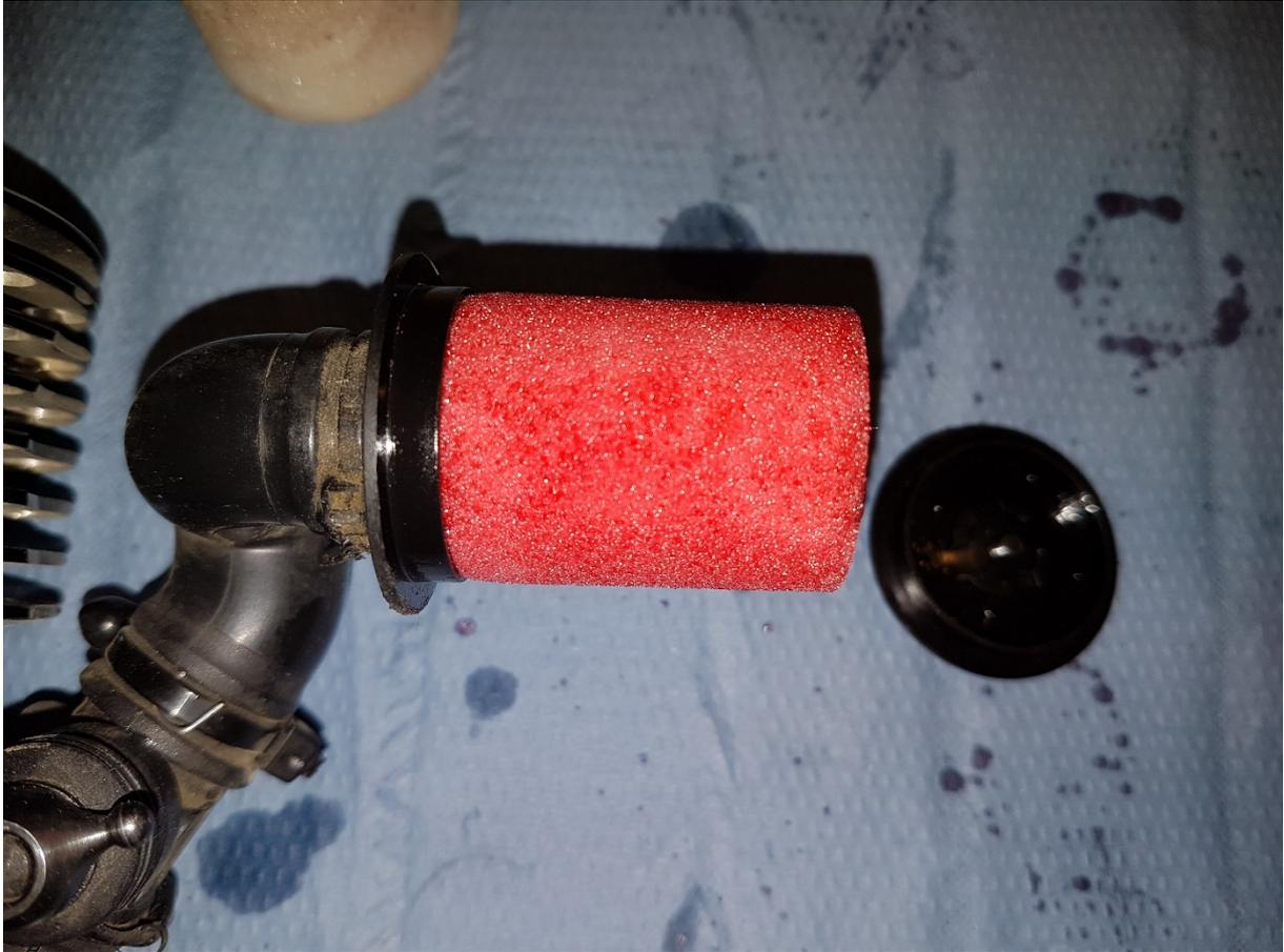
**Das Ganze macht man (mit dem Fett) weil sich im Betrieb das Luftfiltergehäuse verwinden kann und dann nicht mehr 100% gewährleistet ist, dass der Filter auch richtig abdichtet.**
